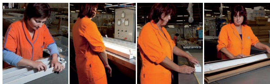
Assembly line final routine test (performed on all EEE luminaires) Teste de fin de ligne (effectué à tous les luminaires)
